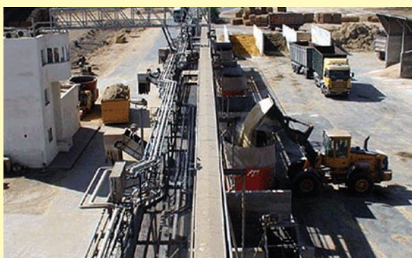
写真5 写真4を上から見たところ。左側のパイプから糖蜜とホエーが流れ、TMRに添加される。水が貴重なために、液体副産物を飼料に混入させている。
